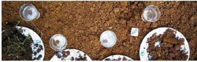
Figura 5. Determinación del grado de la estructura (prueba de Emerson).
