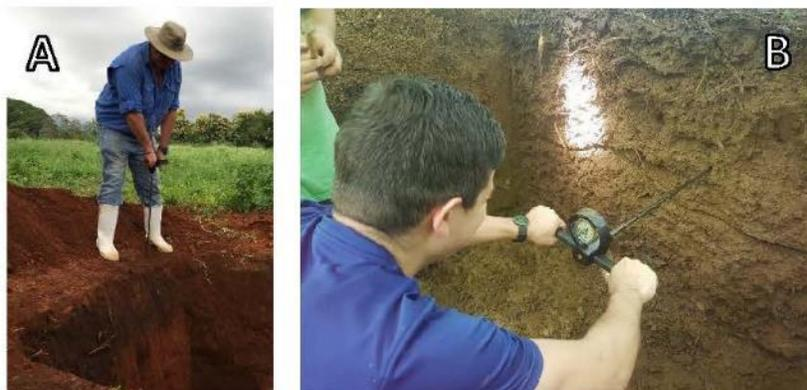
**Figura 9.** Determinación de la resistencia a la penetración del suelo (A) superficial/vertical y (B) por horizontes.
